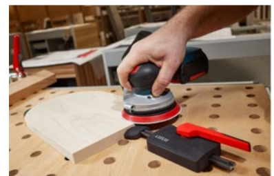
Der BESSEY Waagrecht-Niederzugspanner hält das Werkstück im gespannten Zustand plan auf der Tischfläche.
