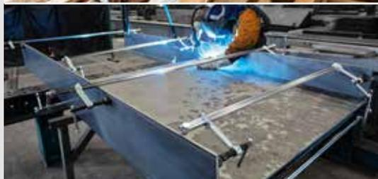
Кроме полностью смонтированных комплектов высокоэффективных струбцин компания BESSEY предлагает также принадлежности с разными вариантами их комбинирования друг с другом. Уже установленные подвижные скобы можно переустановить с зажима на распор либо заменить на другие скобы, а также установить дополнительные скобы.
