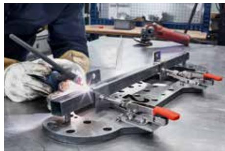
**Sistema di serraggio ad asta di spinta con piastra di base orizzontale STC-IHH**
