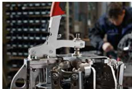
**Sistema di serraggio verticale con piastra di base orizzontale STC-VH**
